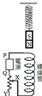
8. 有一電磁感應裝置如下圖。開始時，甲電路上的開關  $T$  是打開的，甲、乙兩電路均無電流。
